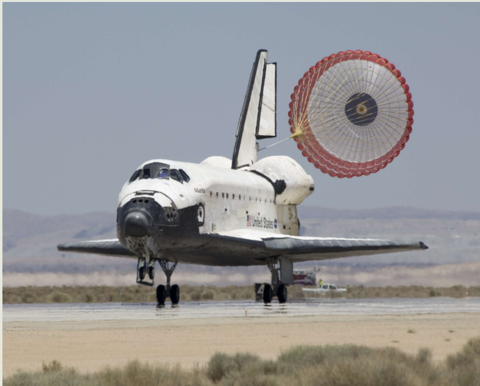
Déploiement du parachute pour réduire la distance d'arrêt (ici Atlantis).
